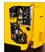
采用CANbus技术的垂直安装驱动电机降低了布线复杂性，提高了可靠性
