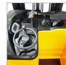
带死机断电开关的大型驾驶室，多功能显示：电池状态、电度表、故障指示灯等
