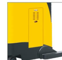
侧电池带推出系统，更换电池方便。电池上盖，方便充电
