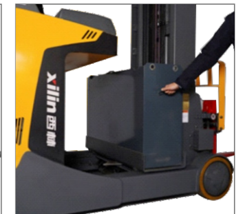
• 电池可随门架一同移出，侧拉结构方便维护及更换电池。
